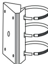
3. Закрепите основание на столбе и затяните кольца с помощью зажимных винтов (по часовой стрелке).
